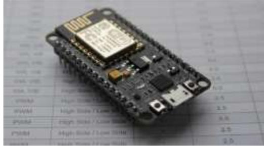
Figure 3: NodeMCU 8266
